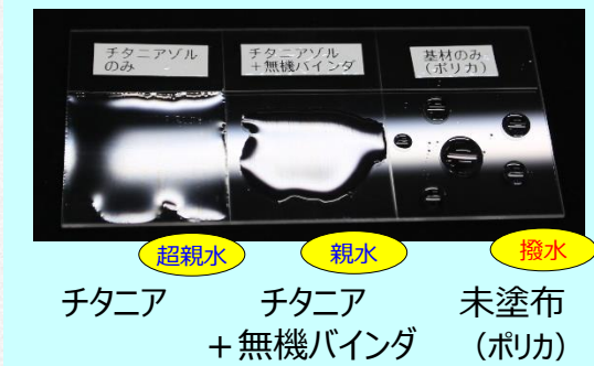
超親水 親水 撥水 チタニア チタニア + 無機バインダ 未塗布 (ポリカ) 透明性・密着性・超親水性 (樹脂にも塗布可能)
