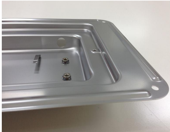
ステンレス板厚0.5mmを 立体成形加工
