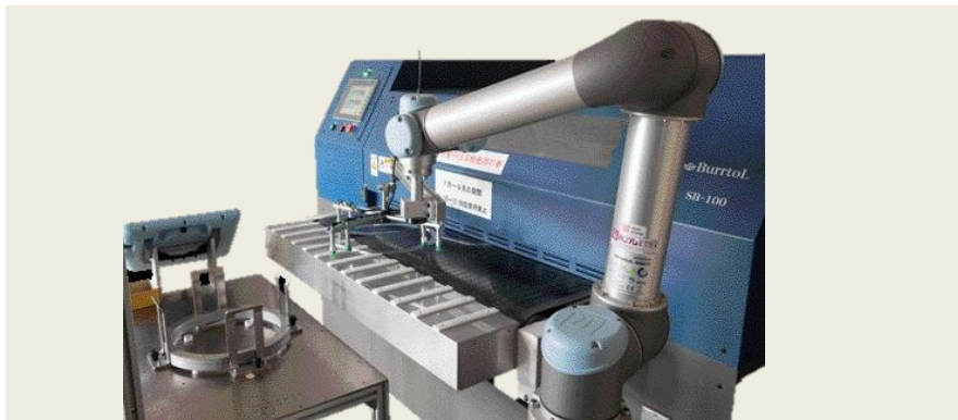
バートル+ウエハーリング供給ロボット
