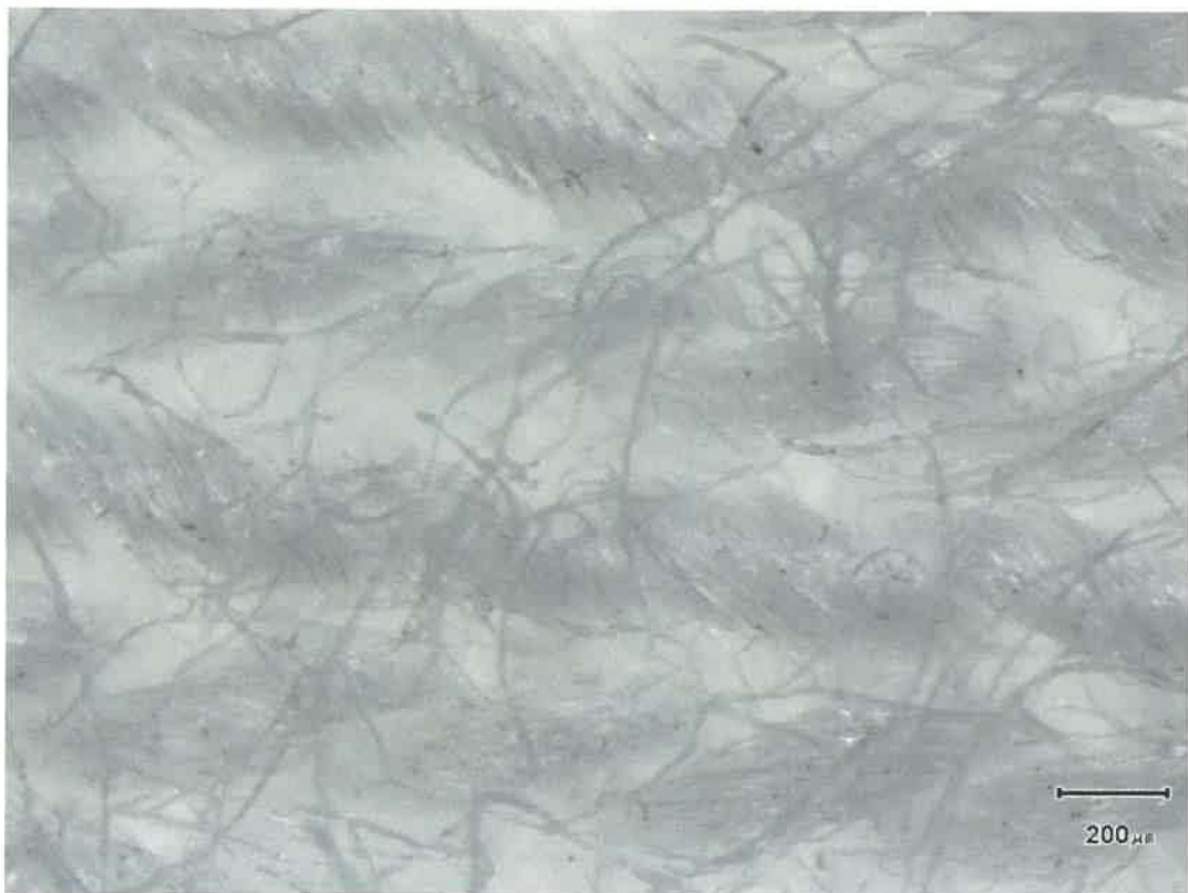
写真4. 抗菌防カビフィルム_試験後綿布片_拡大像
