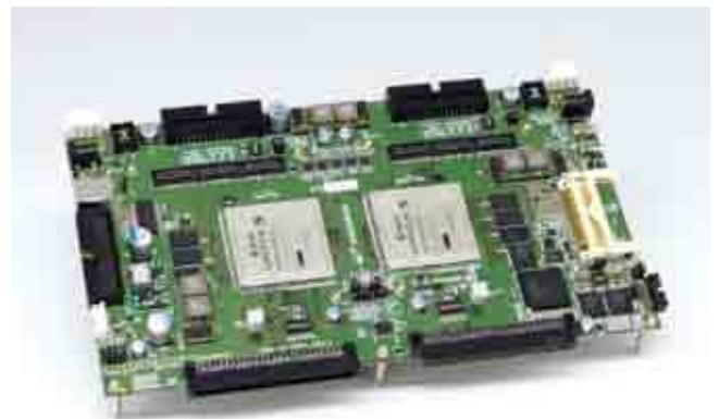
コスモ製汎用FPGAボード。 このボードに信号処理回路を搭載する
