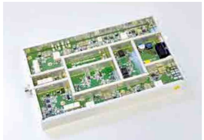
ITSの公開実験に使用された700MHz帯の送受信機
