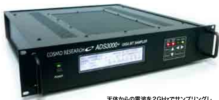
天体からの電波を2GHzでサンプリングし デジタルデータ化する装置
