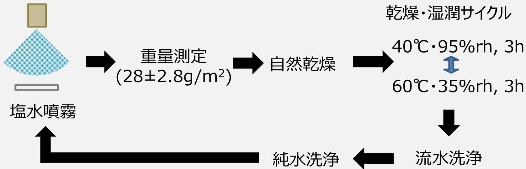
・試験用として鋼板表面に錆を生成する方法として、例えばJIS G0594:2019 D法のように塩水噴霧後に乾燥・湿潤を繰り返す方法などがある。
